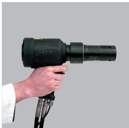
Outil d'installation hydraulique. Installation des boulons sertis de gros diamètre de 14, 15,9, 16 et 19,1 mm ainsi que des rivets aveugles de structure BOM de 15,9 et 19,1 mm.
