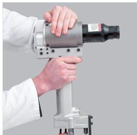
Outil d'installation hydraulique compact, avec nez de pose coulissant. Installation des diamètres de 14 et 16 mm Boulons sertis Huck-Spin.
